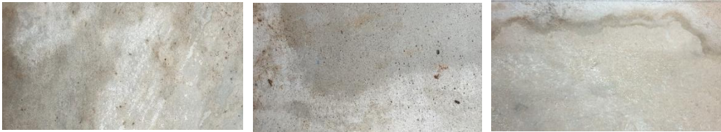
ภาพที่ 10 ภาพตัวอย่างการทดสอบการต้านทานการรั่วซึมของแผ่นซีเมนต์เส้นใย
