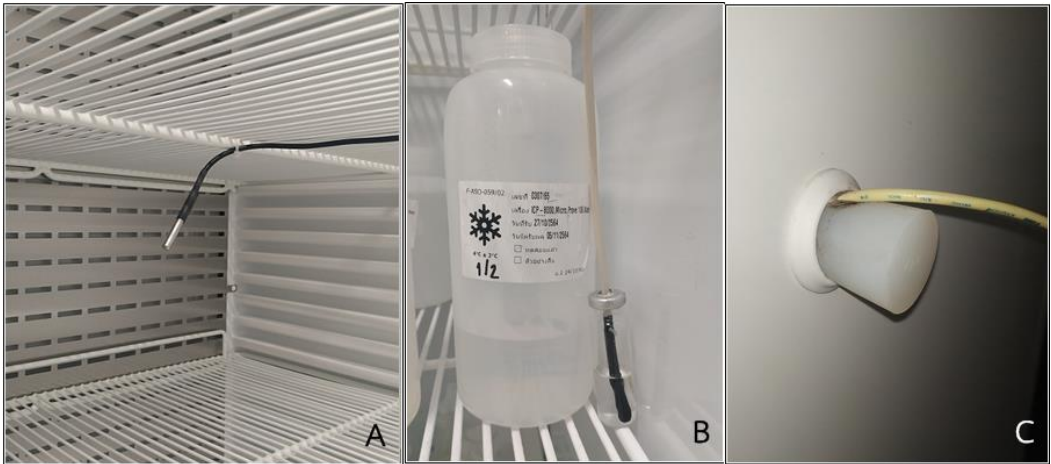
ภาพที่ 5 ตำแหน่งการวางเซ็นเซอร์วัดอุณหภูมิกึ่งกลางตู้แช่ (A) ในสารละลาย (B) ผ่านช่องสำหรับสอบเทียบของตู้แช่ -55°C (C)
