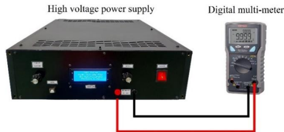
ภาพที่ 6 การทดสอบศักย์ไฟฟ้าเอาต์พุตกับความถี่ และแรงดันที่จ่ายให้ชุดคอยล์
