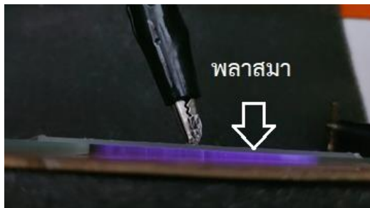
ภาพที่ 12 พลาสมาของอากาศที่เกิดจากโครงสร้างไดอิเล็กทริก แบรีเออร์ ดิสชาร์จ อย่างง่าย
